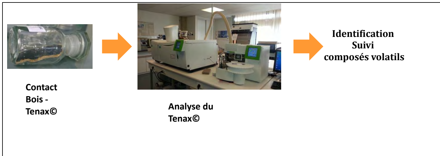
Figure 2 : Méthode par TD-GC/MS pour la Migration Spécifique des emballages en bois de peuplier et pin maritime
